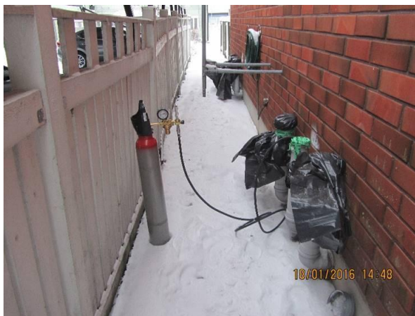
Kuvat 12. ja 13. Ilmavuodot paikannettiin merkkiainekokein
