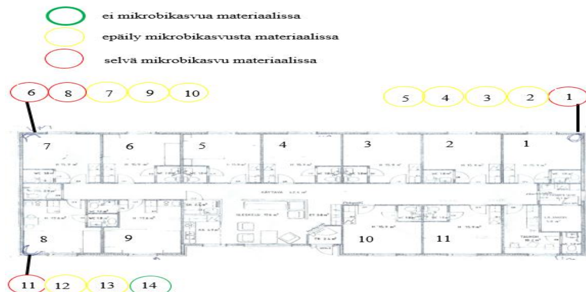
Kuva 8. Materiaalinäytteiden näytteenottopaikat ja mikrobikasvun määrä.
