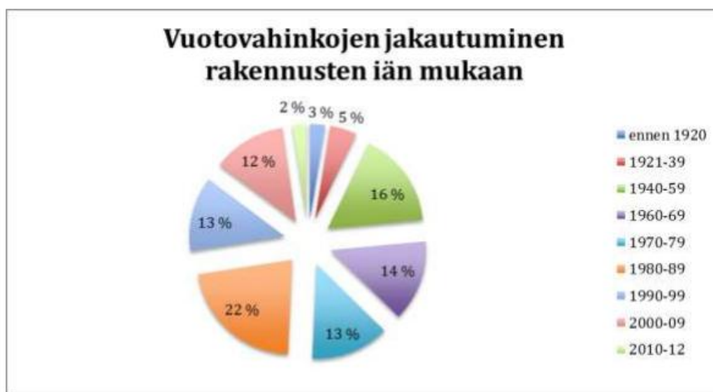
Kuva 3. Vuotovahinkoselvitys 2012-2013 vuotovahinkojen jakautuminen rakennusten iän mukaan.
