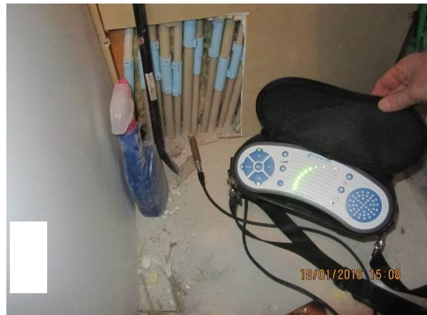
Kuvat 12. ja 13. Ilmavuodot paikannettiin merkkiainekokein
