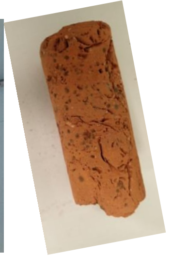
Kuva 15. Yleensä mikrobikasvu alkaa ensin herkimmin vaurioituvassa materiaalissa. Kuva 16. Myös tiilirakenne voi mikrobivaurioitua, jos olosuhteet ovat suotuisat ja aikaa on
