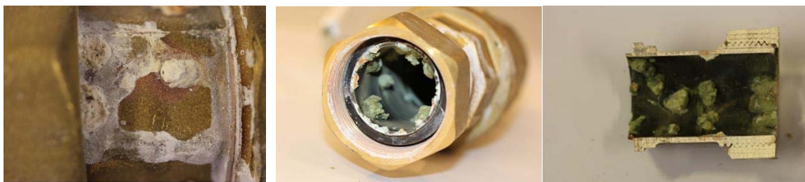
Kuva 1. Kuvissa näkyy viiden käyttövuoden jälkeen sinkinkatoa liittimen pinnalla (marenkimainen saostuma sekä punertavuus liittimen pinnalla, kuva A). Liittimessä näkyy edelleen saostumaa sisäpinnalla (kuva B) sekä poikkileikkauskuvassa (kuva C). (VTT 2016)
