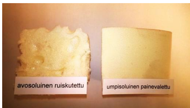
Kuva 4. Avosoluisen ruiskutetun ja umpisoluisen painevaletun eristeen poikkileikkaukset.
