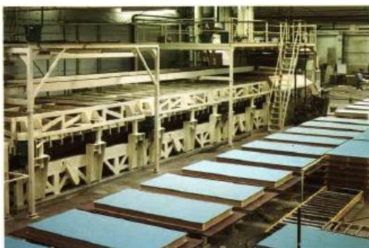
Kuvat 2 ja 3. Polyuretaanieristeiden valmistusta Makrotalo – talotehtaalla.
