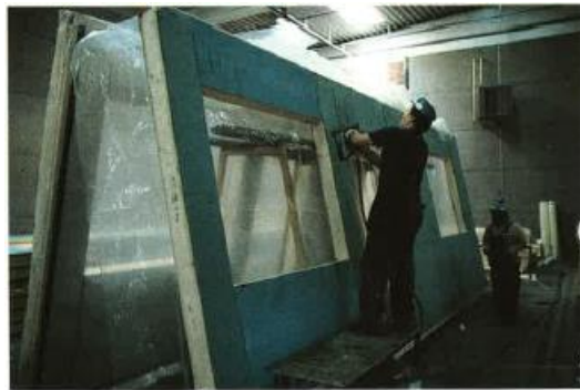
Kuvat 2 ja 3. Polyuretaanieristeiden valmistusta Makrotalo – talotehtaalla.
