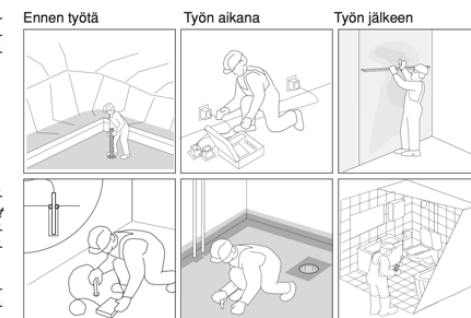
Kuva 1. Työmaan tarkastuksia ja mittauksia ennen työtä, työn aikana ja työn jälkeen.
