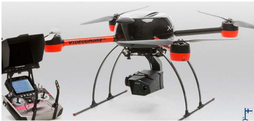
Kuva 1. Lämpökuvaukko: VideoDrone® X4S varustettuna Workswell WIRIS 640 lämpökameralla.
